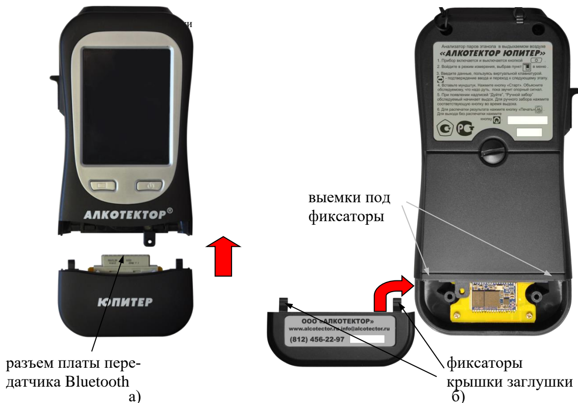
Рисунок 32 – Подсоединение заглушки к основному блоку анализатора
