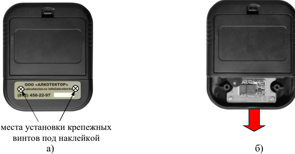
Рисунок 29 – Отсоединение заглушки от приемника Bluetooth
