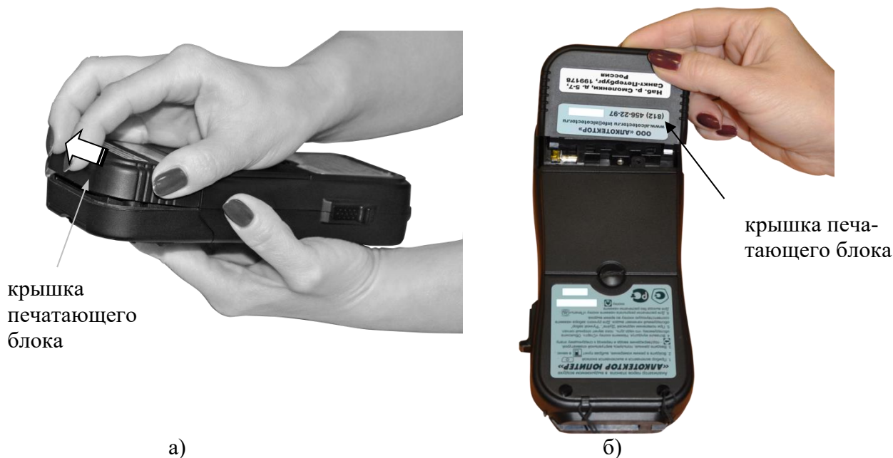
Рисунок 30 – Отсоединение крышки печатающего блока
