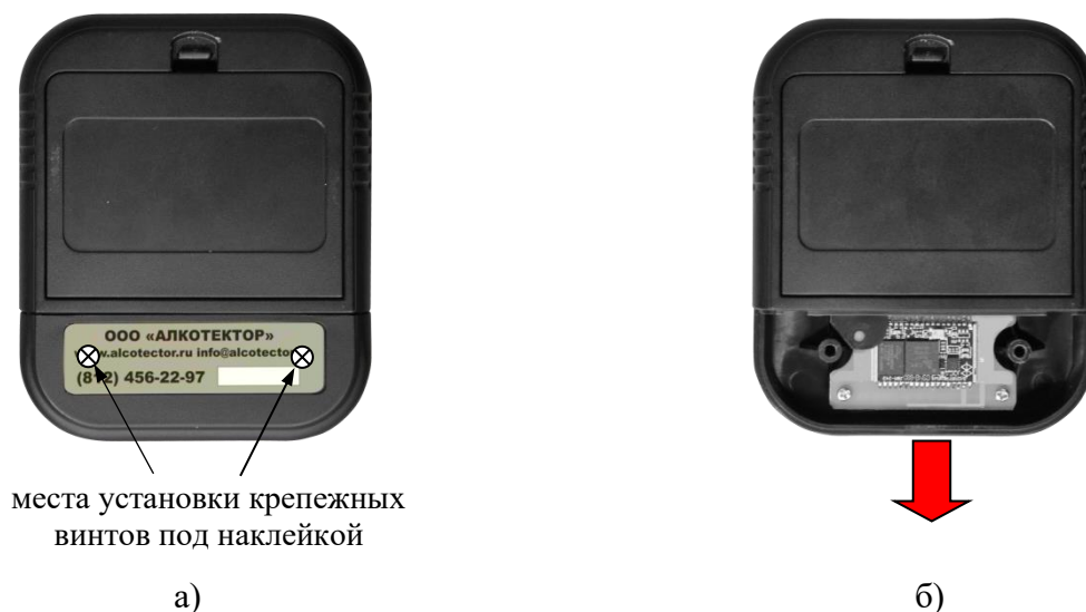
Рисунок 29 – Отсоединение заглушки от приемника Bluetooth
