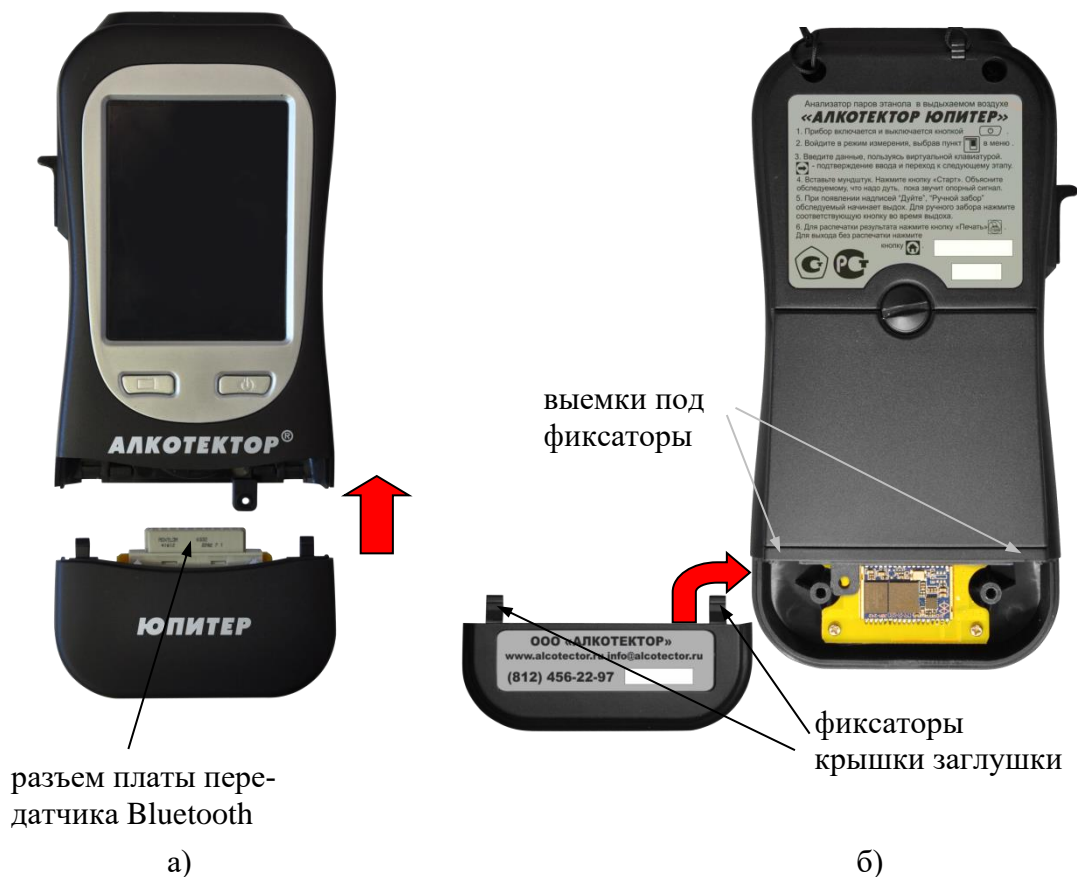
Рисунок 32 – Подсоединение заглушки к основному блоку анализатора
